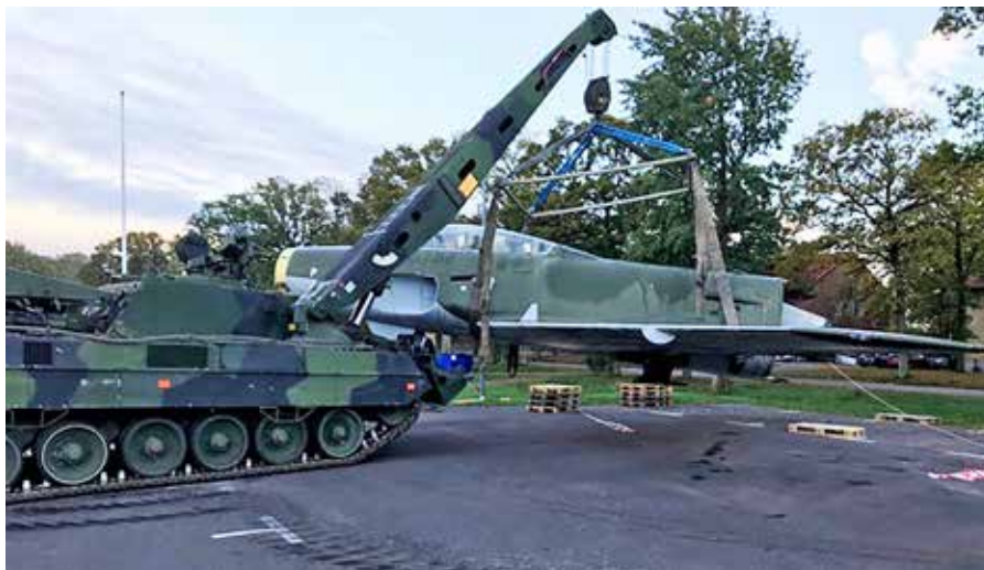
Med hjälp av stridsvagnsbärgare placeras Lansen på ett lastbilssläp. Foto: Hans Hansson.
